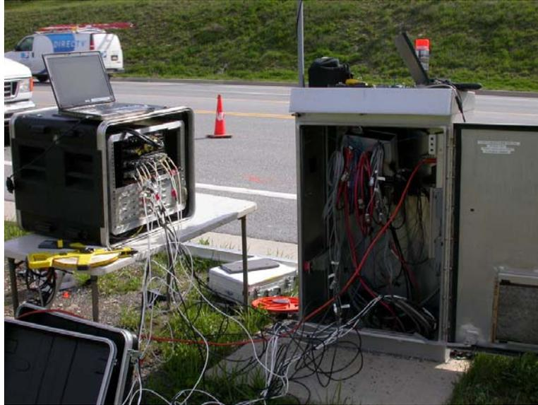
**Figure 15. Dynamic data collection apparatus**
